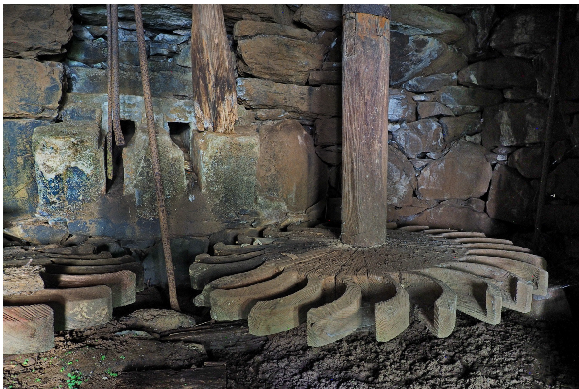
Figura n.º 9 – Rodízios Clássicos de Madeira, Moinho da Fonte Vermelha ou do Abel, Marroços
